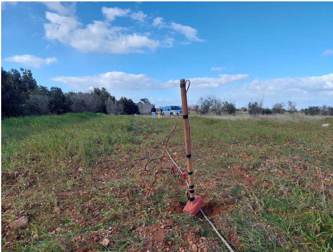
Foto 2: Fase di esecuzione indagine sismica (B-B' e MASW2)
