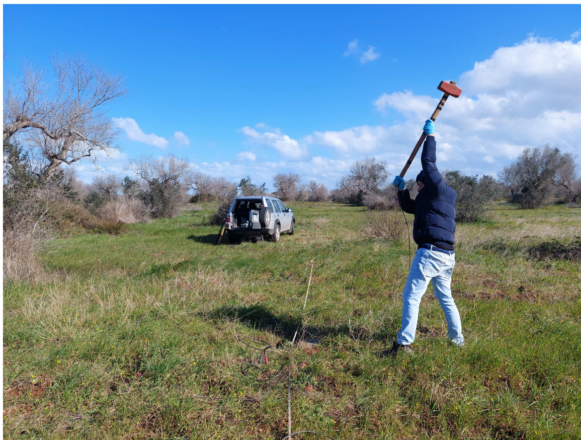
Foto 1: Fase di esecuzione indagine sismica (A-A' e MASW1)
